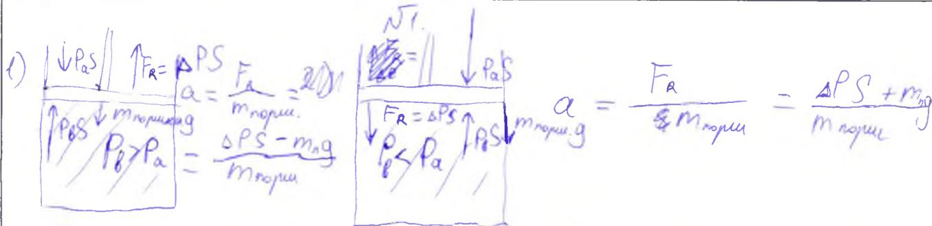
Если на поршне не лежит груз, то после его освобождения поршень начнет двигаться с ускорением в сторону равнодействующей силы, т.е. вверх, если давление внутри сосуда больше атмосферного, или вниз, если давление в сосуде меньше атмосферного. По второму закону Ньютона ускорение
